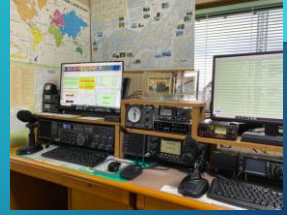
左より YAESU FT5000Limited(HF~50MHz FT8) Icom 9100(HF~1200MHz) YAESU FT991AM(HF~430MHz) 上段中央 アンテナ制御器(上下・回転)
