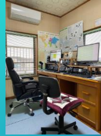
左より YAESU FT5000Limited(HF~50MHz FT8) Icom 9100(HF~1200MHz) YAESU FT991AM(HF~430MHz) 上段中央 アンテナ制御器(上下・回転)
